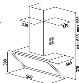
misura da spigolo inferiore cappa a spigolo superiore del raccordo scarico aria X = 430 mm
