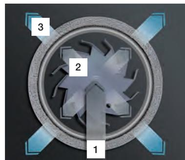
**Una soluzione pulita!** L'aria carica di grassi, odori e sostanze in sospensione viene aspirata dalla ruota del ventilatore (1). Questa fa passare l'aria carica attraverso la resistenza direttamente nel catalizzatore (2). Tutti i residui vengono trasformati in acqua e anidride carbonica. L'aria pulita viene ricondotta nel forno (3). In questo modo non vi sono depositi all'interno del forno e non necessita una pulizia impegnativa.
